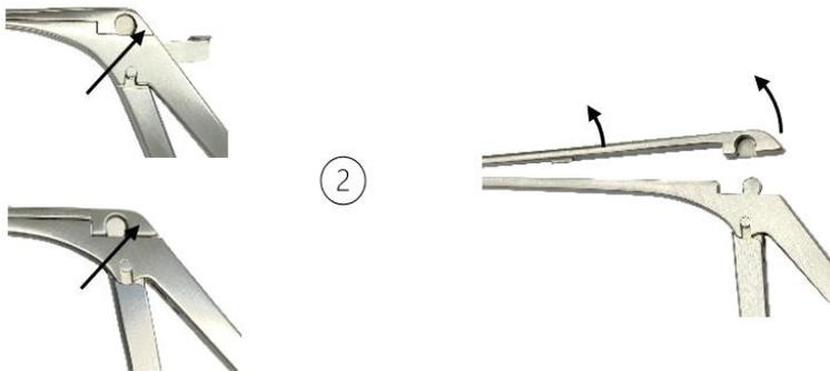
3. Lösen Sie das bewegliche, abnehmbare Griffteil aus der Führungsnut (B) des fixen Instrumententeils nach unten hin heraus.
