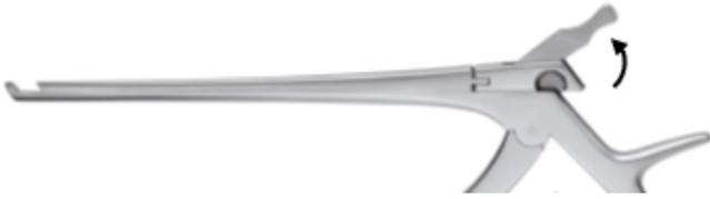
2. Lösen Sie den Öffnungshebel aus dem Pfauenaugenschluss, indem Sie ihn nach rechts drücken.
