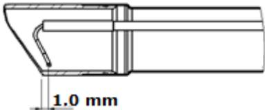
La distancia entre la punta no aislada del electrodo y la punta del endoscopio tiene que ser de al menos 2 mm.
