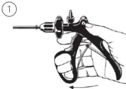
1. Öffnen Sie zum Abschrauben des Rohrschafts das Instrument bzw. den Griff.
