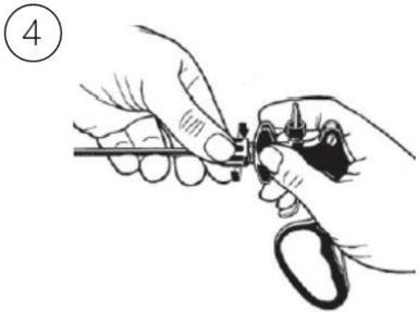
1. Schrauben Sie die Befestigungsmutter im Uhrzeigersinn auf das Aufnahmegewinde des Griffs, und ziehen Sie diese fest.
