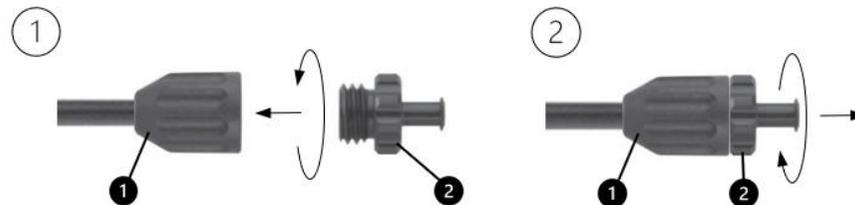
(1) Tubo con vite di fissaggio
