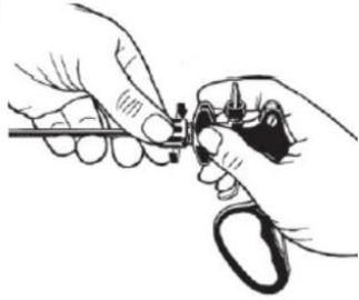
1. Visser l'écrou de fixation dans le sens des aiguilles d'une montre sur le filetage du logement de la poignée et le serrer en tenant l'adaptateur rotatif par la poignée.
