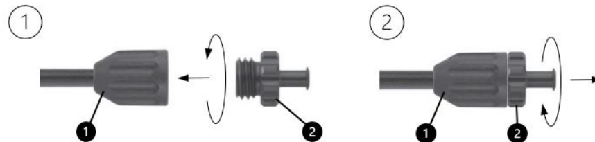
(1) Rohrschaft mit Befestigungsmutter (2) Spülansatz mit Luer-Lock
